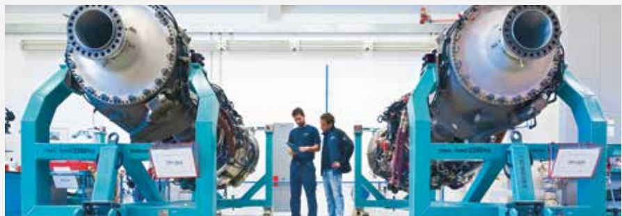
Die MTU verantwortet die Endmontage aller TP400-D6-Serientriebwerke ebenso wie die Serienabnahmetests.
