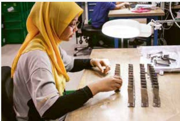
Unter die Lupe genommen: Sichtprüfung von Triebwerksschaufeln
