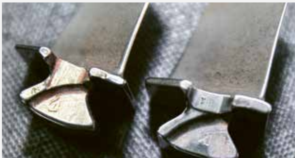
Aus alt mach neu – Schaufeln im Vergleich
