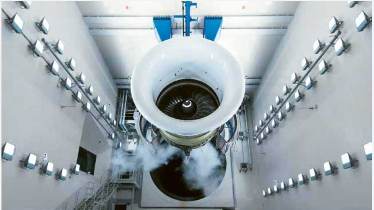
Ein GE90 Growth wird zum Abschluss der Instandhaltung einem Prüflauf unterzogen – angepasst an den Umfang des Shop Visit. Zwei Prüfstände gibt es am Standort Hannover: einer bis 100.000, der andere bis 150.000 Pfund Schub.
