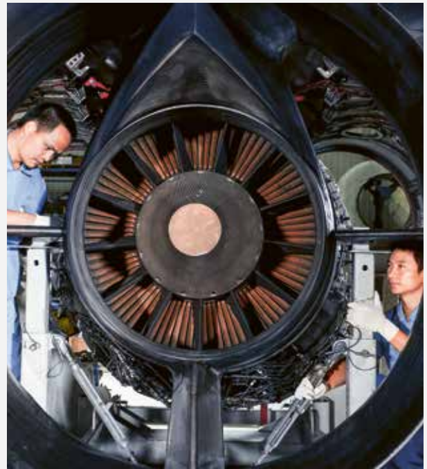
Alles im Griff: Mit viel Fingerspitzengefühl wird eine V2500-Austrittsdüse fachkundig montiert.
