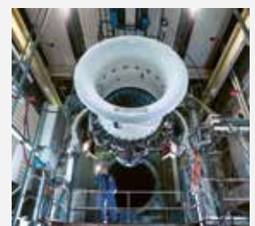
Test auf Herz und Nieren: Ein CF34 wird auf den Prüflauf vorbereitet.
